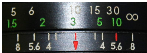
ILUSTRACION 8: Anillo de escala de profundidad de campo
