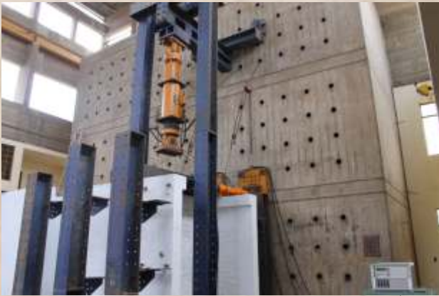
Muro de reacción para pruebas estructurales CISMID
