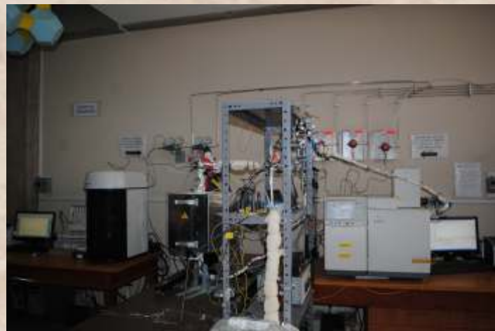
Equipo de solución catalítica en línea con el cromatógrafo de gases FC
