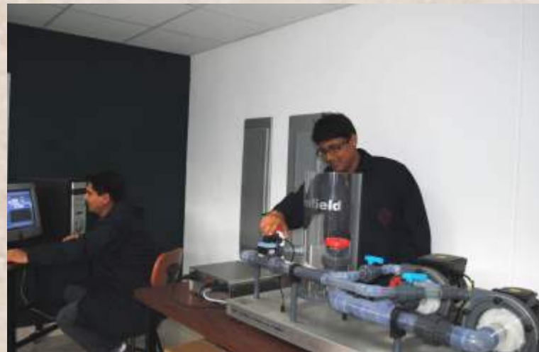
Banco de pruebas de bombas FIM
